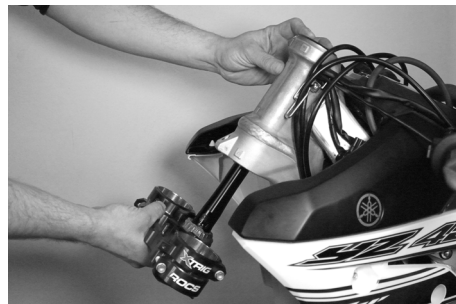
Die untere Gabelbrücke in den Lenkkopf einschieben, dabei das obere Lenkkopflager und die Dichtscheibe gegenhalten.
