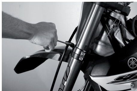
Démontez le guidage de la durite de frein avant.
