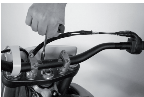
Startnummerntafel modellabhängig demontieren
