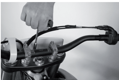
Démontez la plaque de numéro frontale.
