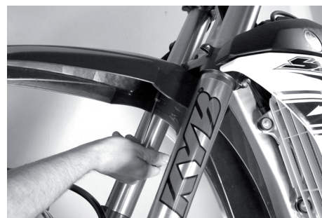
Démontez le garde-boue avant.
