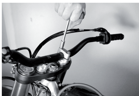
Lenker und eventuelle Befestigungen wie Kabelbinder demontieren
