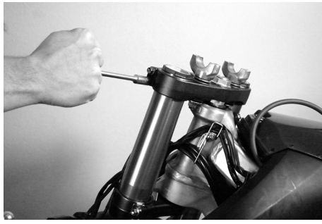
Klemmungen der Gabelbrücke lösen.
