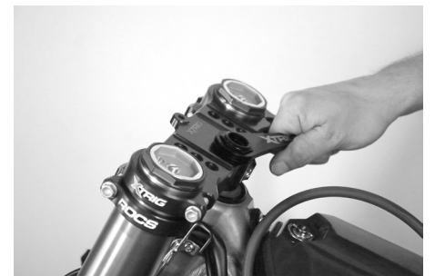
Das gewünschte Lagerspiel mit der Einstellmutter ( 4 ) einstellen.
