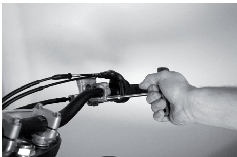
Démontez le maître-cylindre de frein.
