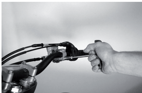
Démontez le maître-cylindre de frein.
