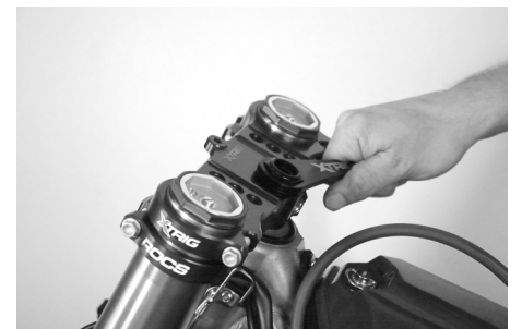
Das gewünschte Lagerspiel mit der Einstellmutter ( 4 ) einstellen.
