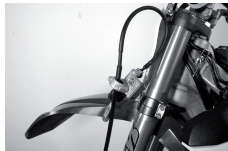
Bremspumpe an Bremsleitung montieren
