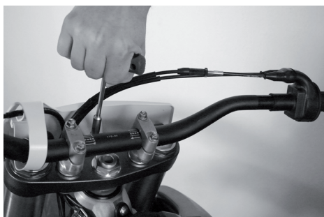
Démontez la plaque de numéro frontale.
