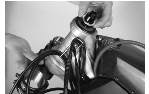
Nun Modellabhängig die Abdichtung für das Lenkkopflager montieren (Dichtscheibe oder O-Ring)
