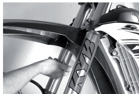
Démontez le garde-boue avant.
