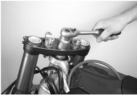
Befestigungsmutter der oberen Gabelbrücke lösen
